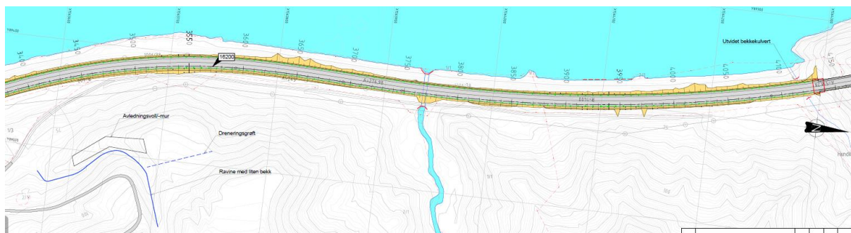
Figur 10: Utbedring av E6 sør for Håggåtunnelen med tiltak for å styre overvann og redusere rasfare. Kilde: Norconsult.
